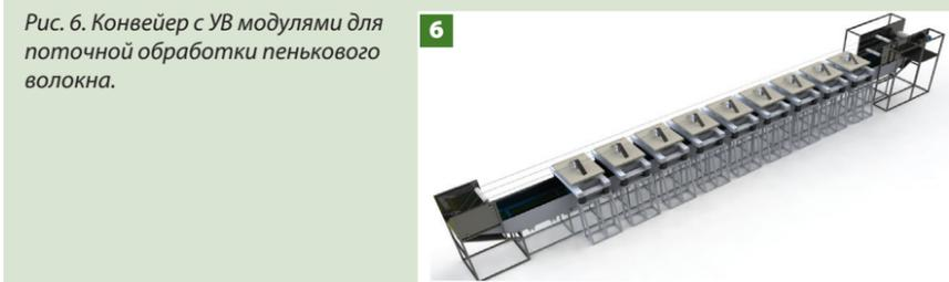
ковой обработки УВ-обработка сырья происходит в наполненной водой лотке конвейерной линии с волокном, перемещающимся под УВ-баками; волна попадает на слой волокна на конвейере через эластичную мембрану в днище УВ-бака, в котором инициируются электроимпульсные разряды микросекундной длительности с частотой следования от 1 до 3 Гц. При поточном варианте механизация переходов осуществляется в автоматическом режиме, производительность поточной линии зави-
